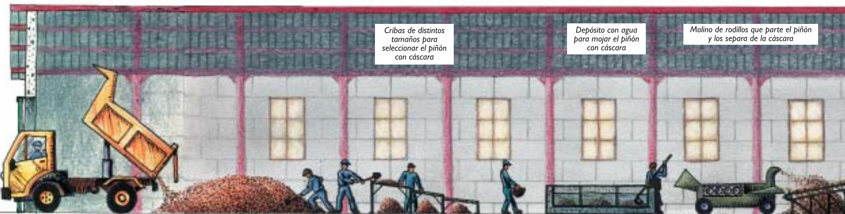
DESCARGA EN EL INTERIOR DE LA FÁBRICA REMOLQUE Y TRACTOR O CAMIÓN
