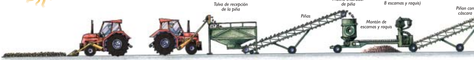
CARGA DE LA PIÑA PARA LA ALIMENTACIÓN DE LA CADENA DE EXTRACCIÓN
