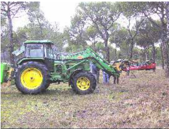
Figura 7.- Tractor agrícola preparado para accionar la pinza vibradora montada sobre la pala, y con una bomba hidráulica en la parte posterior.
